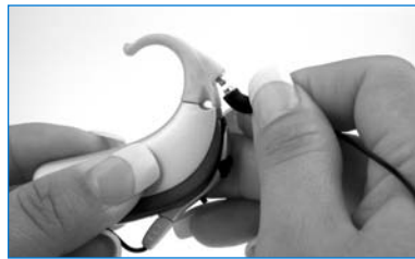
FIGURE 10: Connexion du câble au coude Auria Direct Connect
