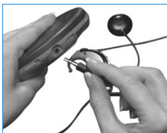
FIGURE 9 : Auria Direct Connect avec adaptateur mono/stéréo pour utilisation de la FM
