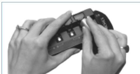
FIGURA 21 : Inserción de la PowerCel™ Auria™ en el cargador
