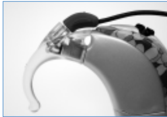
FIGURA 8 : Cable del conector directo Auria™ al procesador HiRes™ Auria™
