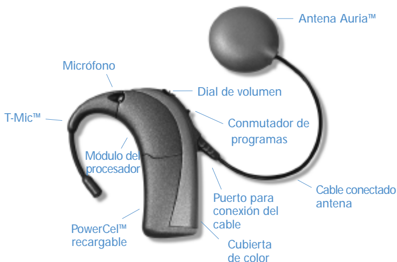
FIGURA 1: Procesador HiRes™ Auria™ con componentes
