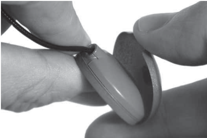
Abbildung 2: Entfernen der Überträgerkappe.
