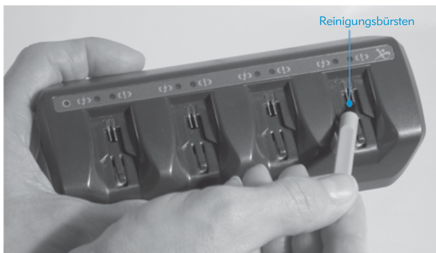
Abbildung 16: Reinigen des Ladegeräts.
