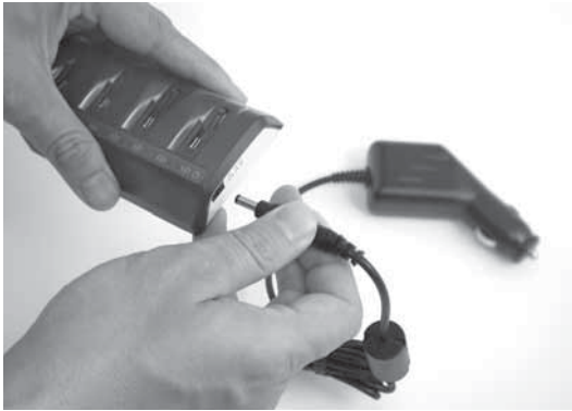
Abbildung 14: Verwenden des Autoadapters für das PowerCel-Ladegerät.
