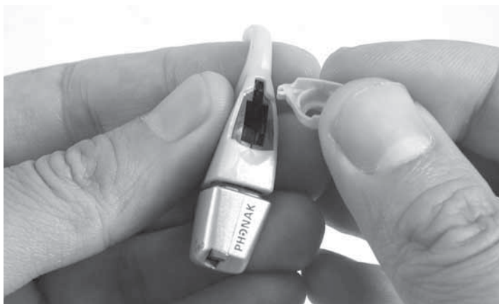
Abbildung 30: Installieren eines neuen Batteriefachs.
